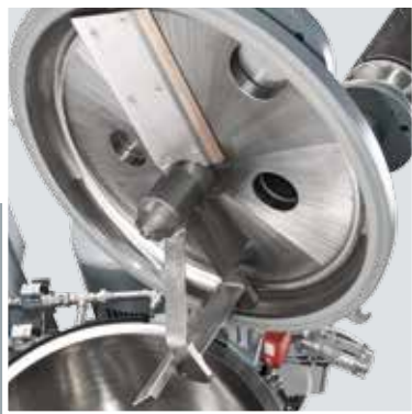
Klappdeckel mit Wand- und Deckelabstreifer
