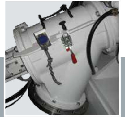
Auslauf-Reinigungspaket inklusive Blasdüsen
