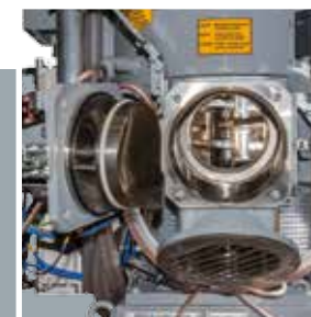
Auslauf mit Reinigungsklappe Discharge with cleaning cover
